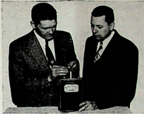
Batterij, waarbij radio-actieve straling via warmte wordt omgezet in elektrische energie. Een voltmeter geeft de spanning aan van de batterij.
